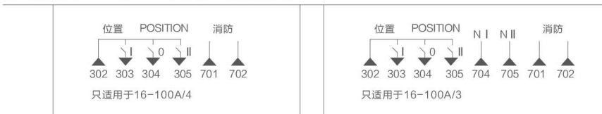
普通+(消防 无源.DC24V,AC220V)型控制电动转换开关接线图 16-100
